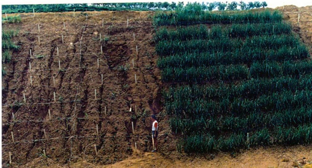
Figura 4 - Ensaios foram realizados em encostas típicas e diversas gramíneas foram comparados e testadas. Nesta imagem o vetiver foi usado, em comparação com as
