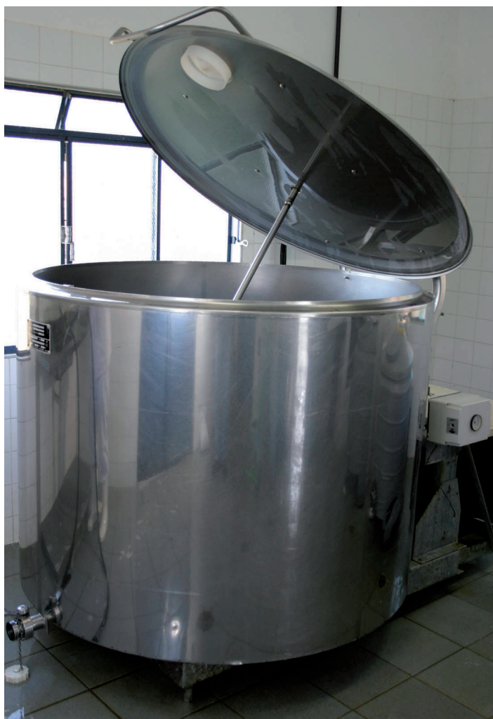
Tanque de refrigeração aberto para secagem
