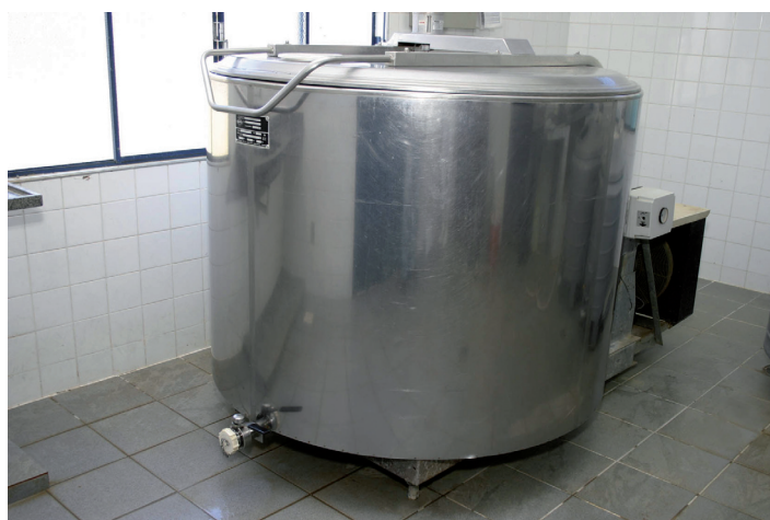
Tanque de refrigeração
